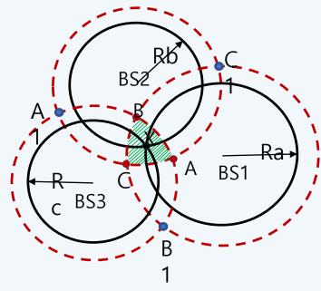
图 巷道内三点定位方案示意图
